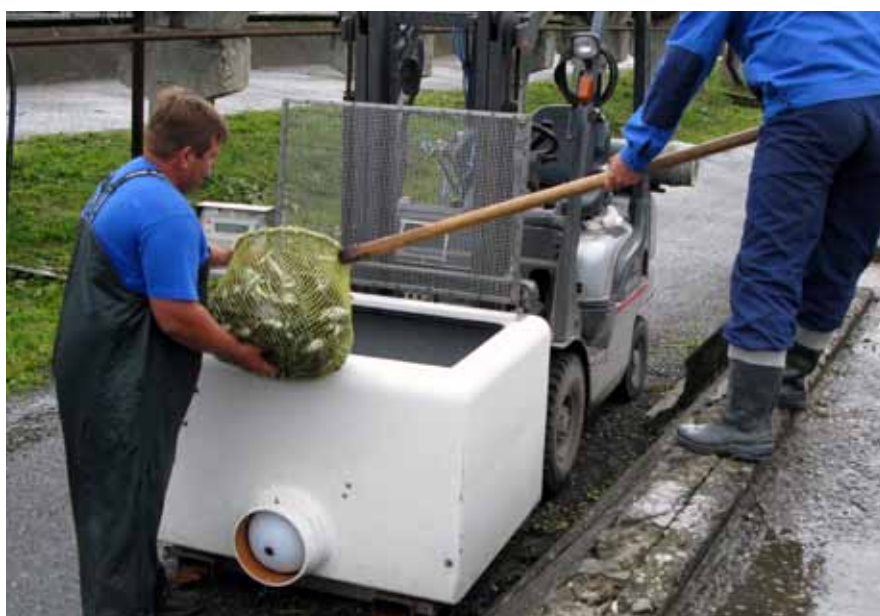
Живую рыбу помещают в залитую водой изотермическую камеру с весовым механизмом.
