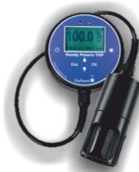
Измеритель общего давления газа «Handy Polaris TGP»
